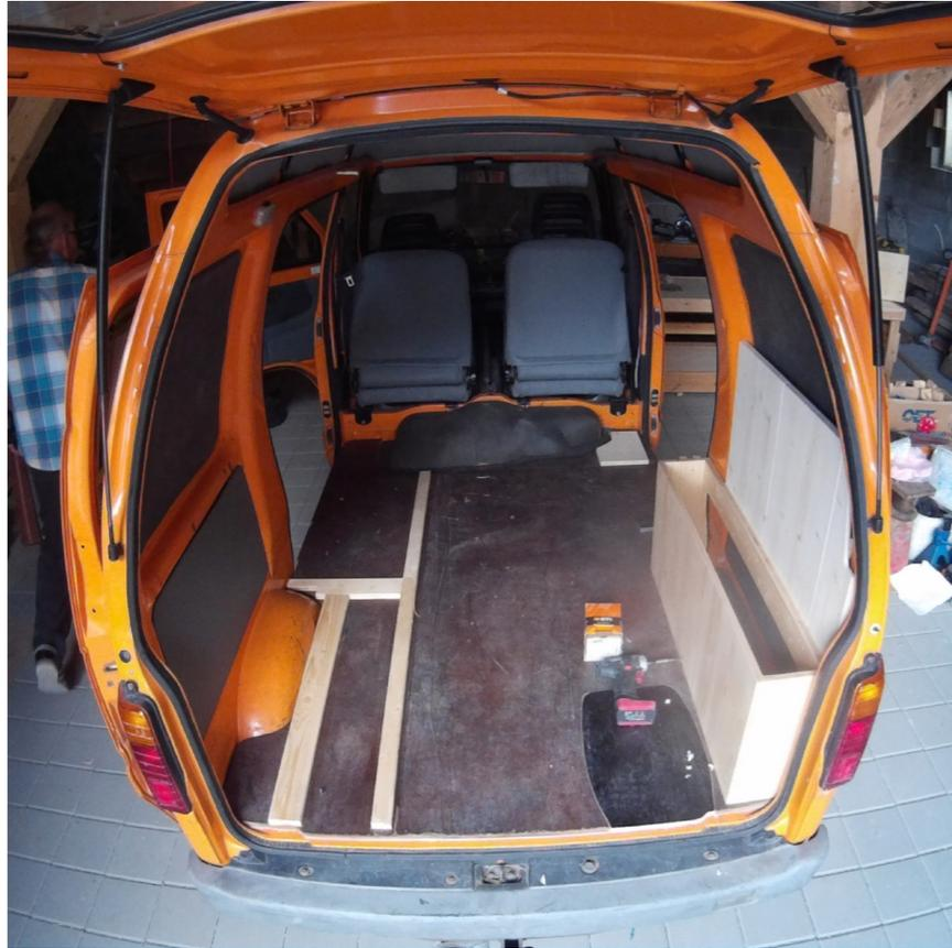
Abb. 26 Unterkonstruktion\_Regal
